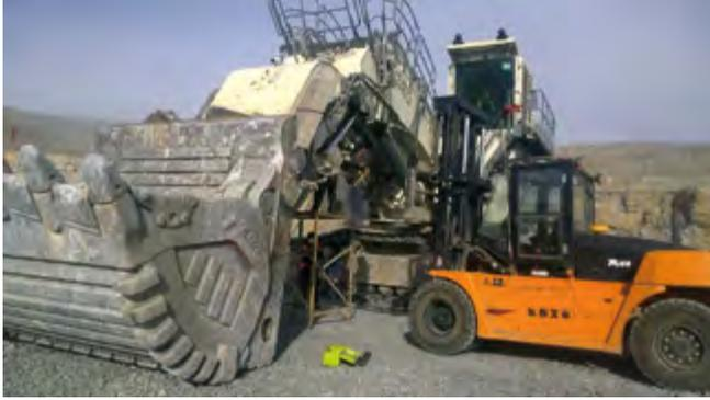
3月9日星期一，在客户召开的晨会上得到通知，要求我们售后维护队伍通过两天时间，对一台利勃海尔ER9350液压铲进行大保养，同时还要完成对铲斗进行焊接加固和更换漏油的液压油散热器这两项维修任务。真是时间紧，任务重。
