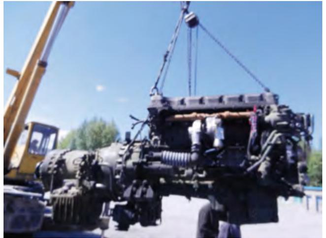
3月9日早晨，启动4号车开始磨合，然后就是处理5号车变速箱液压刹车失效问题。首先是对电气方面的检查，通过资料查询，车辆对比，排除了电气方面出问题的可能。又对变速箱各个压力的检测，发现最终变速箱内部液力变矩器输出的压力在发动机1100转时是1.6B,而正常值则在2.5B以上，这就说明液力变矩器出现了问题，而这些问题在云南同事的大力支持下都得到了解决。
